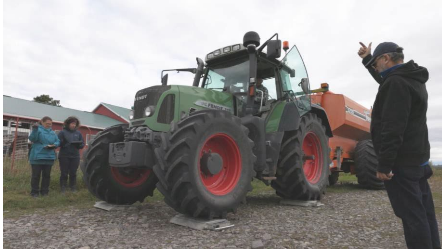
Figure 26 – Pesée de la machinerie agricole pour connaître sa charge à la roue (IRDA, 2022)
